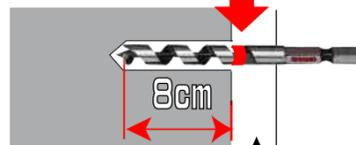
※モルタル壁面は10.5Mコンクリートドリルで柱材木部面まで取除く。
